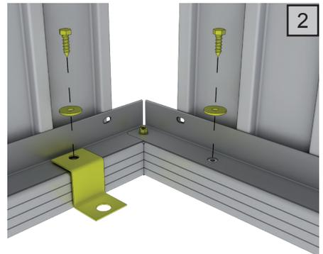
Die **Verankerung** des Gerätehauses machen Sie mittels der Bodenbefestigungswinkel wie folgt:
