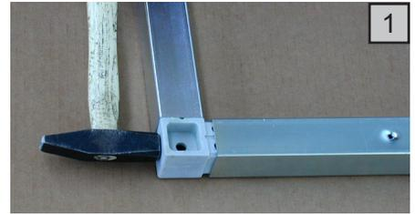
Die Bodenprofile des Gerätehauses werden gemeinsam mit den Bodenbefestigungswinkeln ( z-förmig ) mit den Sechskant-Blechschauben/Beilagscheiben am Bodenrahmen verschraubt.
